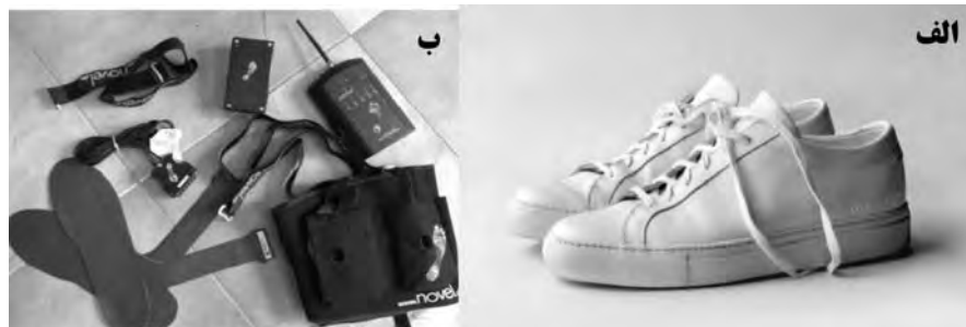
تصویر ۱. الف) کفش استاندارد مورد استفاده در این تحقیق؛ ب) سیستم اندازه‌گیری توزیع فشار کف پای
