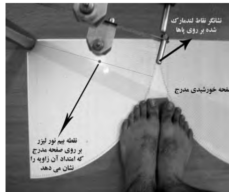
شکل ۴- اجزاء تشکیل دهنده خط کش نمایش گر نصب شده بر روی محور
