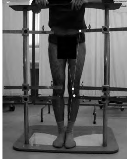
شکل ۳- طریقه ایستادن فرد مورد مطالعه بر روی دستگاه جدید اندازه گیری زاویه کوادریسپس. توجه کنید که چگونه نشان گرهای نصب شده بر روی خط کش ها روی نقاط لندمارک قرار گرفته اند
