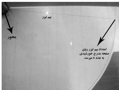
شکل ۴- اجزاء تشکیل دهنده خط کش نمایش گر نصب شده بر روی محور
