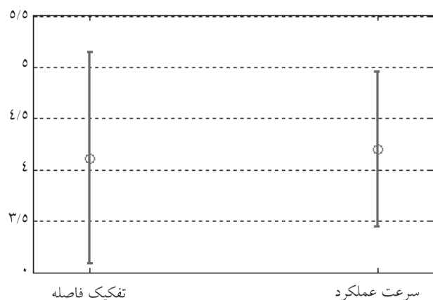
نمودار ۳- میانگین و پراکندگی داده‌های ثبت شده از سرعت عملکرد و قدرت تفکیک فواصل سیستم در افراد مورد آزمایش
