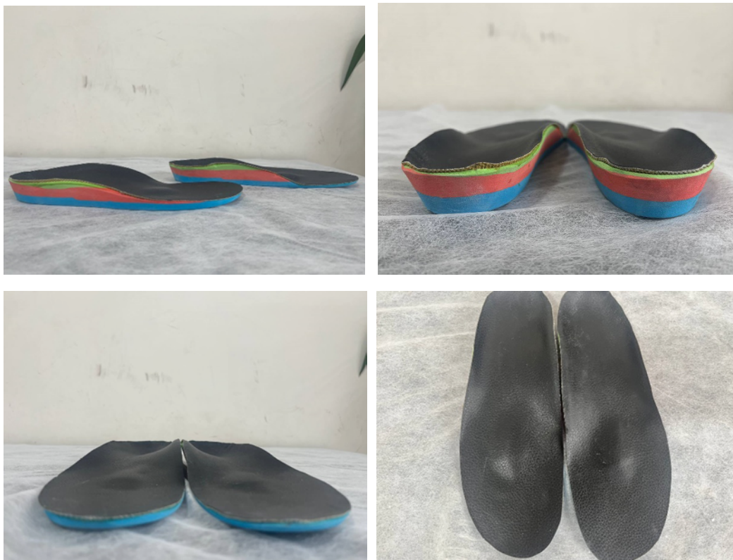
تصویر ۴. کفی پرداخت‌شده و رویه چرمی به آن افزوده شده
