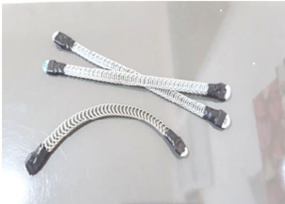
تصویر ۴. فنرهای تعبیه شده در ناحیه زانو و مچ
