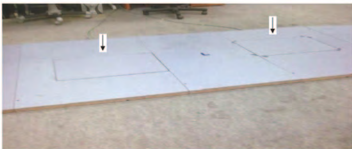
شکل ۳. Force plate walkway در آزمایشگاه ارگونومی دانشگاه علوم بهزیستی و توانبخشی
